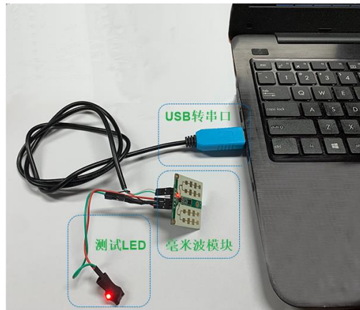
图 2.8 HS2643A 传感器测试连接注释图
